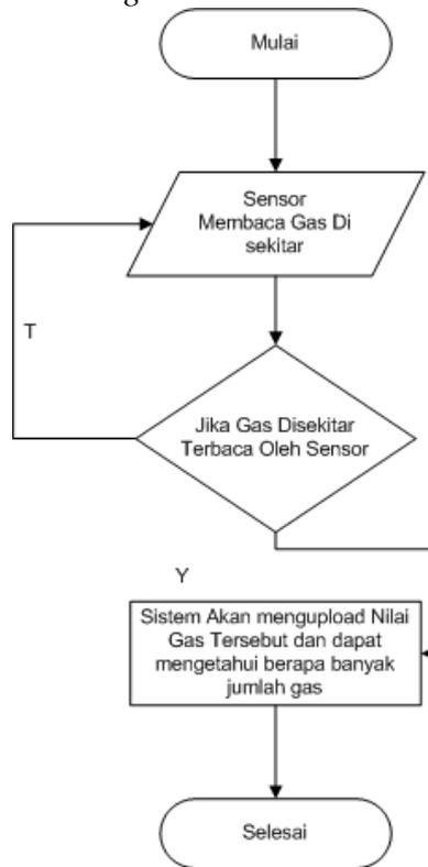
Gambar 4. Diagram Alur Perangkat Lunak Dengan Sensor MQ-2
