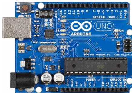
Gambar 3. Arduino UNO (Mikrokontroler ATmega328)
