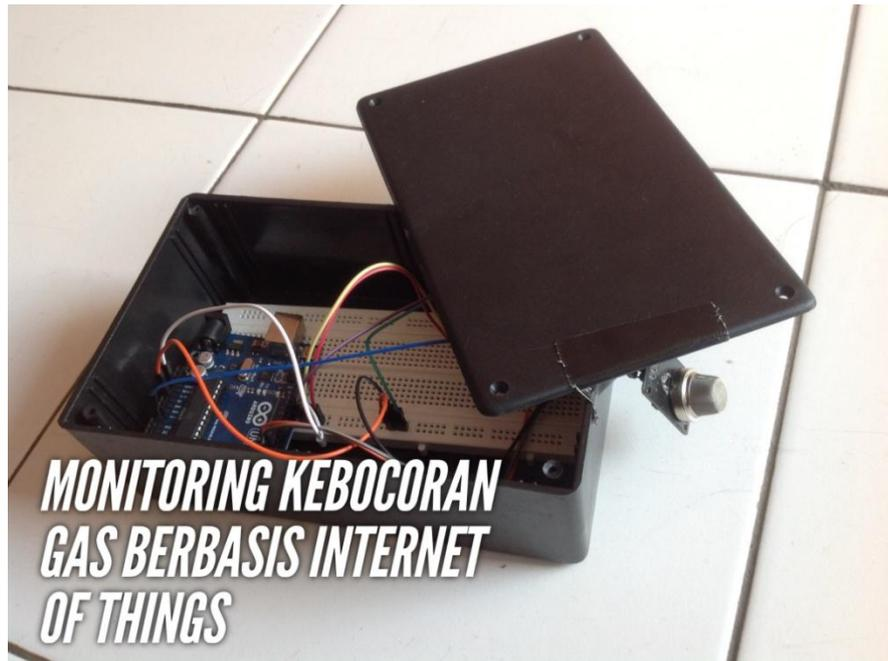
Gambar 9. Pengecekan Blackbox alat Pendeteksi Kebocoran Gas
