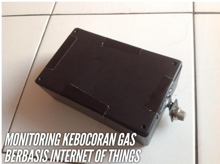
Gambar 10. Alat Pendeteksi Kebocoraan Gas
